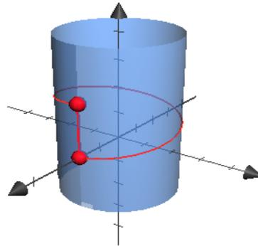
Le cylindre possède une caractéristique qui aide à la compréhension de ses géodésiques : c'est une surface développable. En le faisant rouler, en gardant sa base dans le plan ( $yo$ z), le point  $A = \gamma(\theta, \lambda)$  sur le cylindre, a une image de coordonnées  $(R\theta, \lambda)$  (ici  $R = 1$ ). Cependant, en continuant le déroulement du cylindre, on donne plusieurs images à  $A$  sur le plan. Regardons alors l'image des chemins  $\gamma_1$  et  $\gamma_2$  sur la plan :
