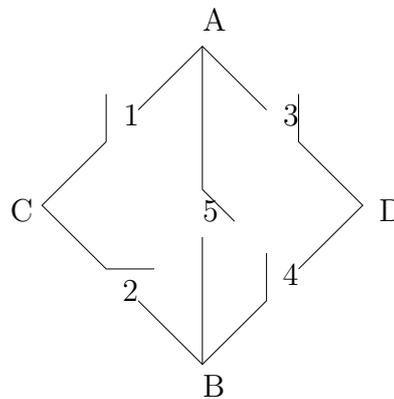
Es bezeichne  $S_i$ ,  $i = 1, \dots, 5$ , das Ereignis, dass Schalter Nr.  $i$  stromdurchlässig ist.
