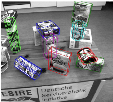
Den erkannten Objekten wird ein Rahmen zugeordnet, wie und wo der Roboter sie im Raum vermutet.
