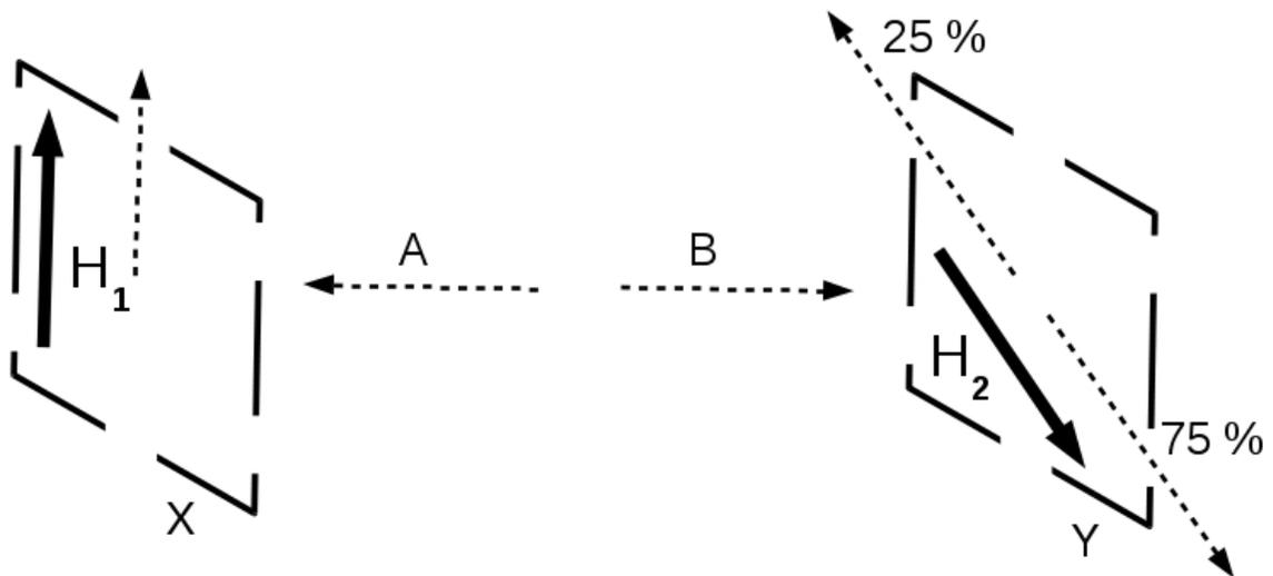
Ici on choisit la direction 1 en  $X$  et la direction 2 en  $Y$ . Si la particule  $A$  va dans la direction du champ, comme dans la figure, la particule  $B$  ira dans la direction du champ dans 75% dans des cas et dans la direction opposée à celle du champ dans 25% des cas (et vice-versa).
