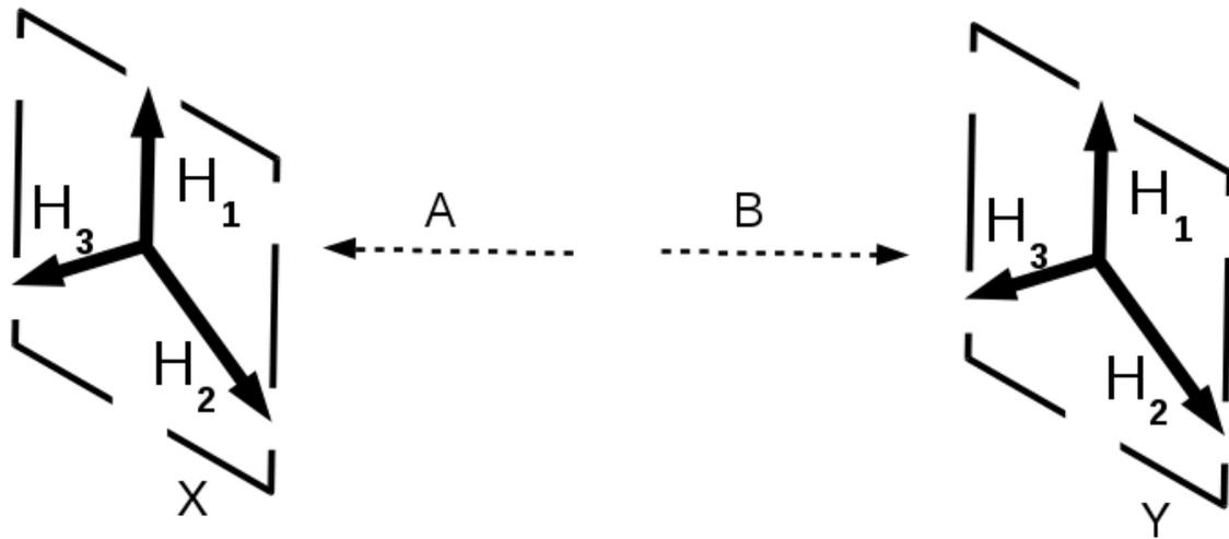
Considérons maintenant trois orientations possibles pour le champ magnétique, dénotées  $H_1$ ,  $H_2$ ,  $H_3$ , dans un plan perpendiculaire au mouvement des particules.
